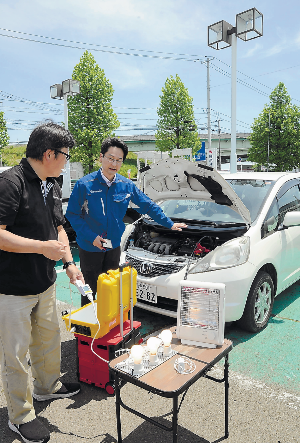
車のバッテリーから電力を供給できることを確認した実験
