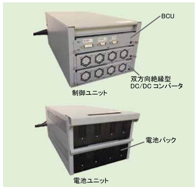
図9 電池ユニットおよび制御ユニットの外観写真
