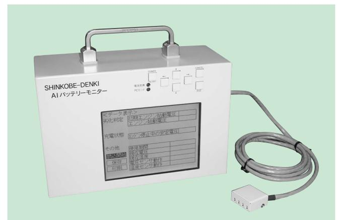
図4 履歴読み出し装置の外観写真
