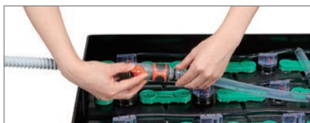
補水開始:コックを開くと自動的に全バッテリーに補水します。(コックは必ず全開にしてください。)
