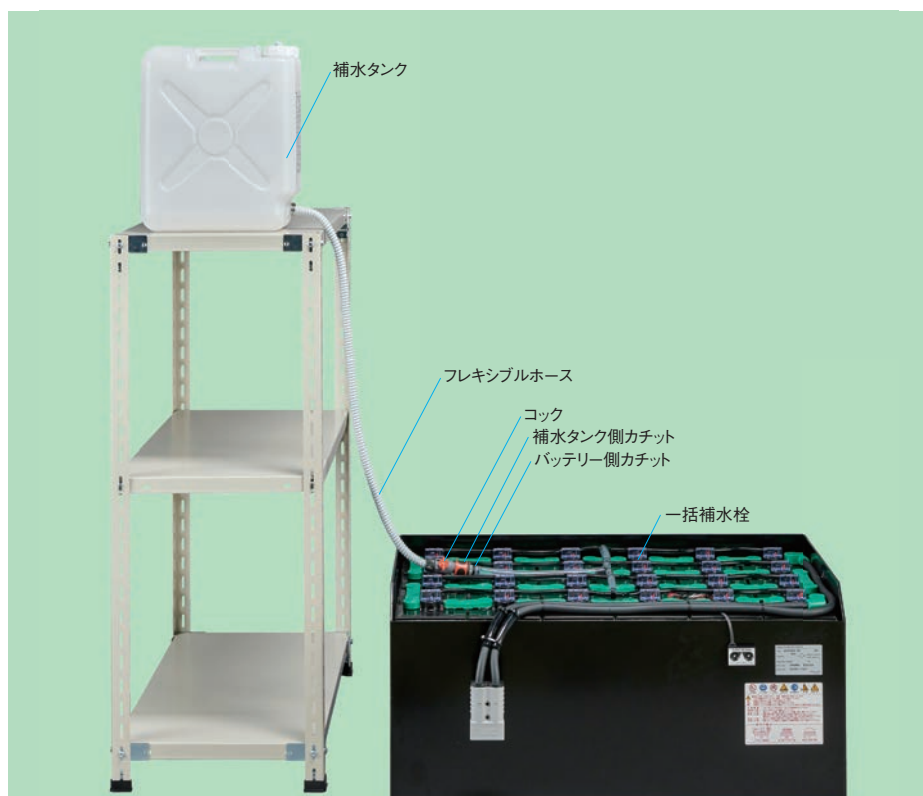
補水開始:コックを開くと自動的に全バッテリーに補水します。(コックは必ず全開にしてください。)
