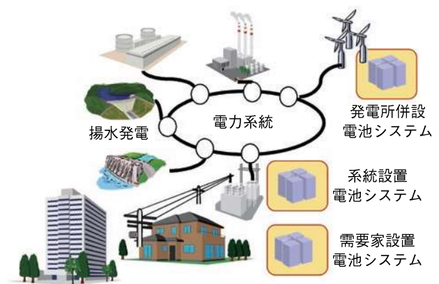
図1 スマートグリッド向け電池システム Figure 1 Smart-grid battery system
