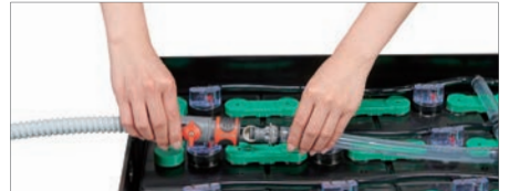
補水準備:補水タンク側ホースとバッテリー側ホースをカチットでつなぎます。
